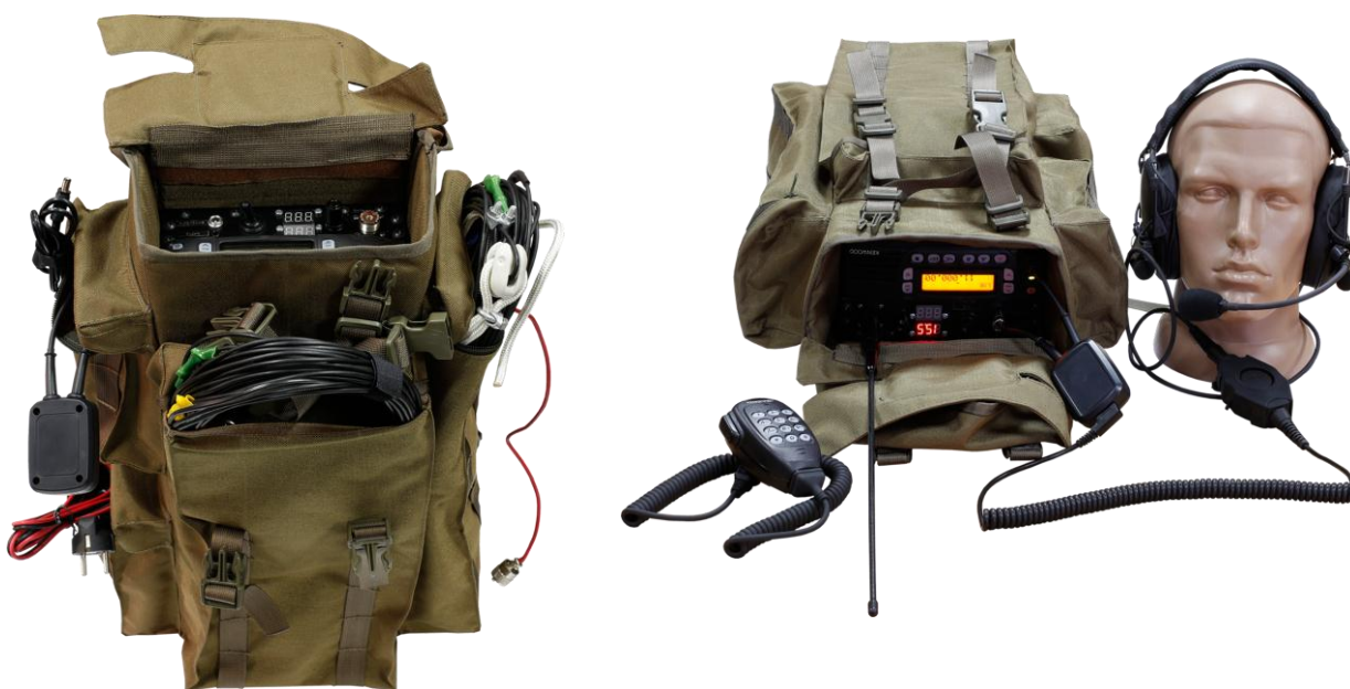
Мал.1 Загальний вигляд переносного комплексу ТК-90
